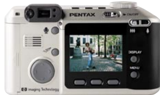
Der 2 Zoll große Niedrig-Polysilizium-TFT-Farblcd bietet eine Auflösung von 130.338 Pixeln und läßt sich in der Helligkeit regulieren.
