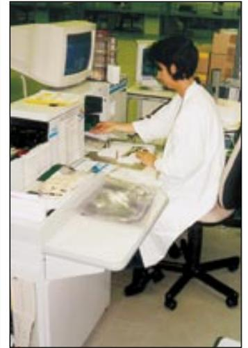
*Der Traum eines jeden Laborleiters hat sich bei fotocolor erfüllt: Die Geräte für die unterschiedlichen Arbeitsstufen, die Bilder zeigen Splicen, Printen und Verpacken (v. l.), wurden hintereinander aufgestellt.*
