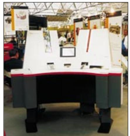
Ergonomie steht bei dem neuen Endverarbeitungsplatz CutFlex von Refrema/Glunz & Jensen im Vordergrund. Der Arbeitstisch ist stufenlos höhenverstellbar, so daß die Bedienung wahlweise im Stehen oder Sitzen erfolgen kann.
