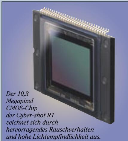
Der 10,3 Megapixel CMOS-Chip der Cyber-shot R1 zeichnet sich durch hervorragendes Rauschverhalten und hohe Lichtempfindlichkeit aus.
