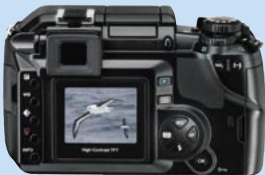
Die Bedienelemente auf der Rückseite der E-300 sind übersichtlich angeordnet.
