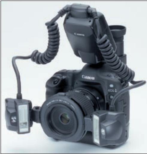
*Eine flexible und präzise Ausleuchtung kleinster Gegenstände ermöglicht das Zwillingsblitzgerät Macro Twin Lite MT – 24EX. Canon vervollständigt damit die umfassende Produktpalette, die das Unternehmen speziell für die Makrofotografie anbietet.*
