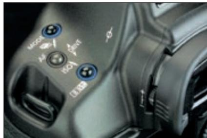
*Alle nach außen hin beweglichen Teile der Kamera wurden gegen Staub und Spritzwasser abgedichtet.*
