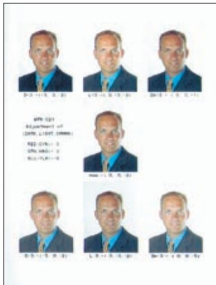
Für die Kalibrierung des Paßbild-Systems gehören zwei Testprints zum Lieferumfang. Mit ihnen können ganz einfach Helligkeit und Farben der Ausdrücke eingestellt werden.
