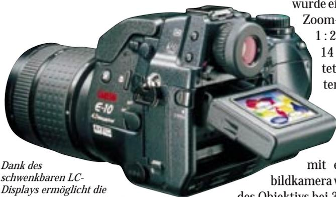
*Dank des schwenkbaren LC-Displays ermöglicht die E-10 auch Aufnahmen in Bodennähe oder aus einer Menschenmenge heraus.*
