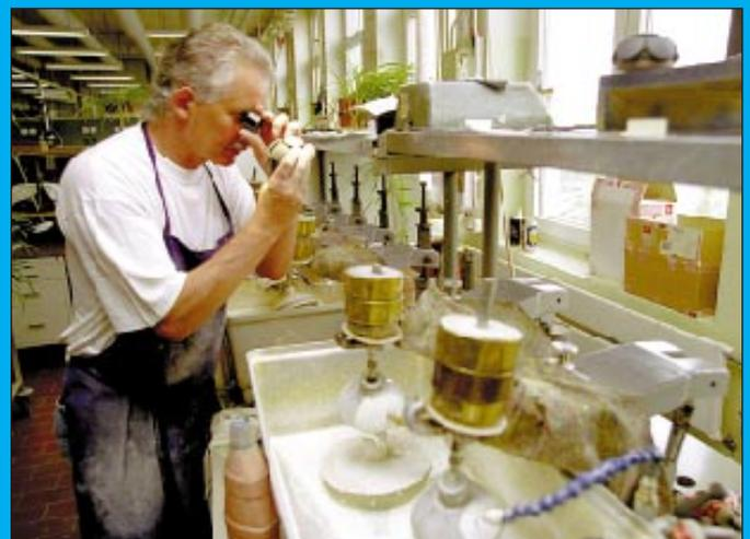
Links: In der Endkontrolle wird jedes einzelne Objektiv geprüft und gegebenenfalls korrigiert. Rechts: Strenge Qualitätsprüfungen, wie hier bei einer Zwischenkontrolle in der Linsenschleiferei, begleiten den gesamten Produktionsablauf.
