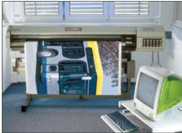
*Mit einem Roland-Plotter können Großformate bis zu 1,30 m Breite im Hexachromeverfahren ausgegeben werden.*
