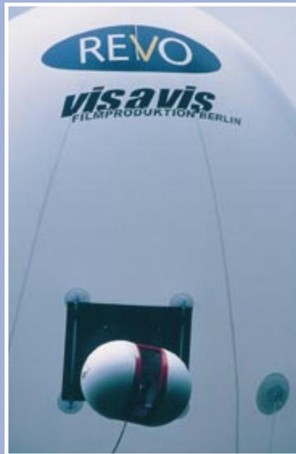
werden. Für Kameras bis 1 kg eignet sich die AirCam 50, die flugfertig knapp 15.000 Mark kostet. In diesem Preis ist ein 5,5 Meter langes Luftschiff mit Kamerasteuerung und Videosystem sowie ein 150 Meter langes Halteseil enthalten. Für schwerere Mittelformatkameras empfiehlt sich die AirCam 60. Infos unter [www.revo.de](http://www.revo.de).
