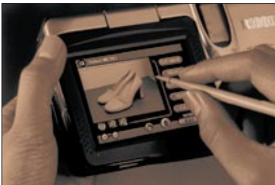
Mit Hilfe des mitgelieferten Griffels lassen sich aufgenommene Dateien gleich am Kameramonitor weiterbearbeiten, in die entsprechenden Ordner ablegen oder für eine der verschiedenen zur Verfügung stehenden Versandformen vorbereiten.
