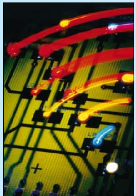
Die nur wenige Zehntelmillimeter großen Leuchtdioden (LED) basieren auf Halbleiterverbindungen, die Strom direkt in Licht umwandeln. Foto: Osram
