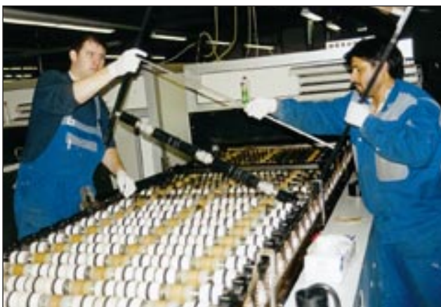
Das Bild zeigt Reinigungsarbeiten an einer Bilddurchlaufmaschine. Saubere Maschinen sind weniger ausfallgefährdet.
