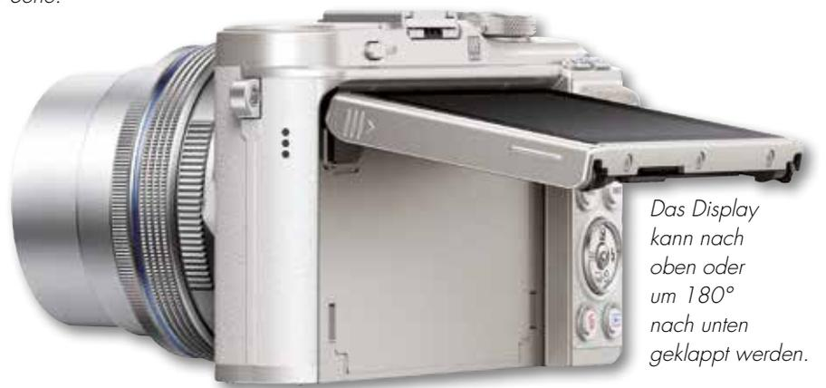
Das Display kann nach oben oder um 180° nach unten geklappt werden.
