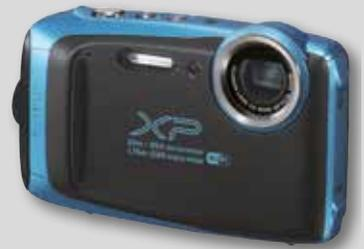
Die nur 207 Gramm leichte FinePix XP130 ist mit einem 16,4 Megapixel BSI CMOS Sensor und einem Fujinon 28-140 mm (KB) 5-fach Zoomobjektiv ausgestattet. Sie nimmt auch Full HD-Videos (1080i) auf und hat eine HDR-Funktion. Auch Zeitraffer-Aufnahmen, bei denen die Bilder-Sequenzen automatisch in ein Video konvertiert werden, sind möglich. Im Serienbildmodus erreicht die Outdoor-Kamera eine Geschwindigkeit von bis zu 10 Bilder pro Sekunde.
