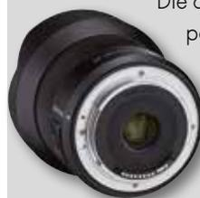
Die optische Konstruktion besteht aus insgesamt 15 Linsen in 10 Gruppen, darunter 7 spezielle optische Linsen für bestmögliche Bildqualität. Zwei weitere Linsen sind asphärisch, vier hochbrechend, und eine der Linsen weist eine besonders niedrige Dispersion auf. Verzerrungen und chromatische Aberrationen werden minimiert.
