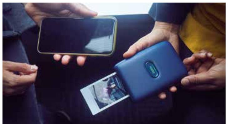
neue Produktkategorie der Smartphone-Printer geschaffen. Der instax mini Link bietet zahlreiche neue Features, kann erstmals bewegungs-sensitiv gesteuert werden und ist mit Abmessungen von 90,3 x 34,6 x 124,5 mm und einem Gewicht von 209 g so kompakt, dass man ihn gerne mitnimmt. Der integrierte Akku ist über den Micro USB Port schnell aufgeladen und hat dann für rund 100 Sofortbilder Strom.
